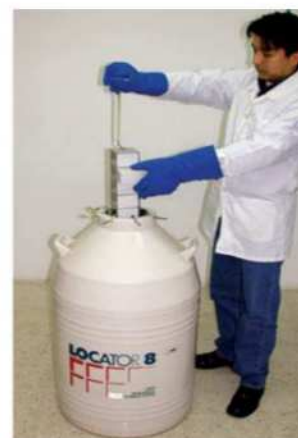
Figura 4. Viales colocados en contenedores de policarbonato congelados en nitrógeno líquido
