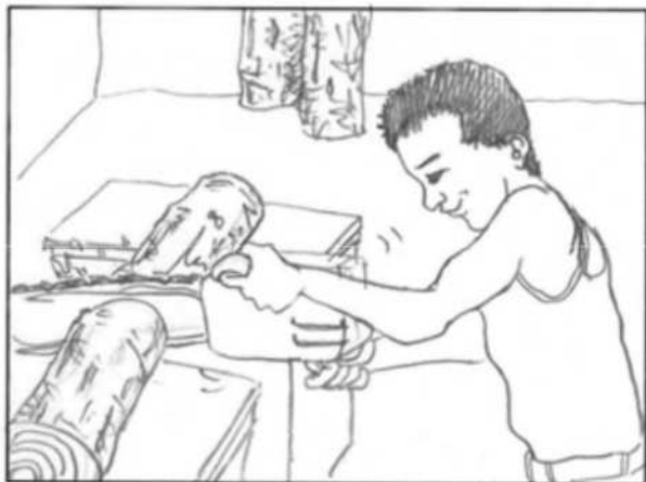
Corte los troncos tumbados con una longitud aproximada de 1-1,2m.
